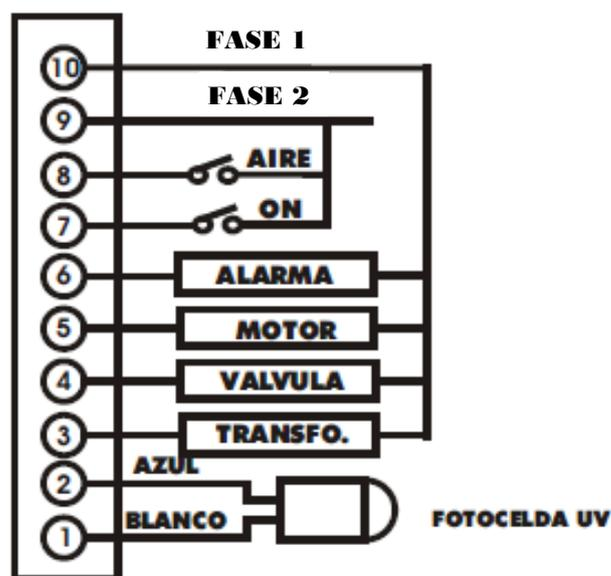
Fig 3 Diagrama de conexión PQ 3004
